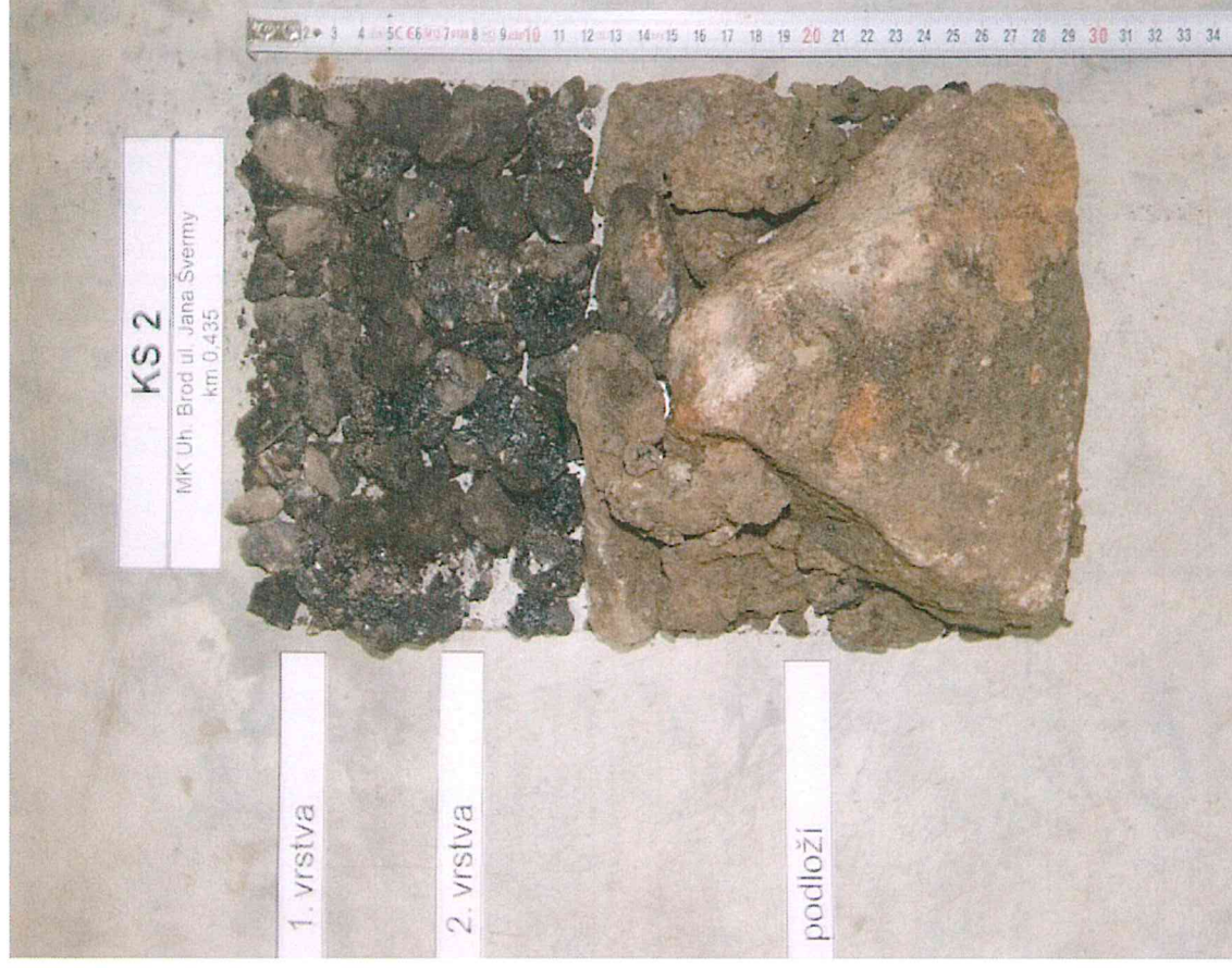
Foto č. 4 – Detail kopané sondy KS 2
